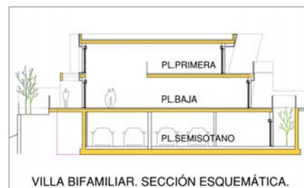
VILLA BIFAMILIAR. SECCIÓN ESQUEMÁTICA.
